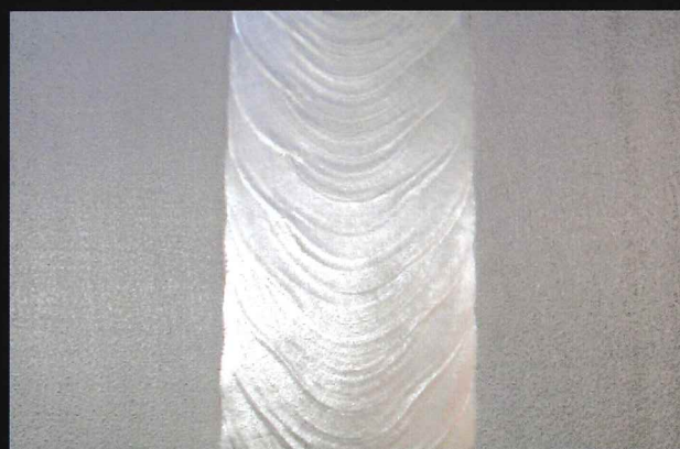
自動溶接の溶接ビード
